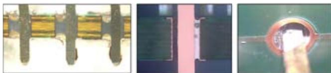
Рис. 1 Возможный результат пайки выводных компонентов с применением технологии Pin-In-Paste
