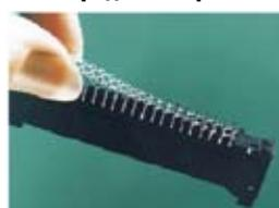
Разъемы с большим количеством выводов присутствуют на многих современных печатных узлах. Пайка таких разъемов выполняется волной или вручную. Это не всегда технологично и эффективно. Выполнить качественную пайку данных компонентов можно с
