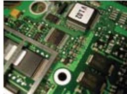
Экраны и некоторые детали печатного узла могут иметь уникальную форму контактной поверхности. Нанесение пасты для пайки таких компонентов в ряде случаев может быть затруднительно. Благодаря любой геометрической форме преформ и широкому спектру
